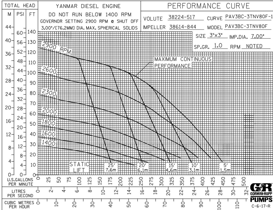
**\* STANDARD PERFORMANCE FOR PUMP MODEL PAV3B60C-3TNV80F FT4**
