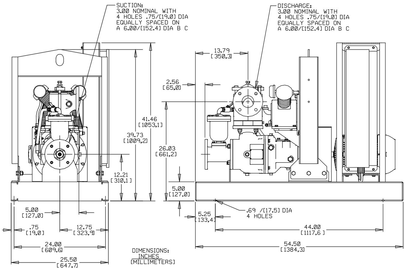
**Figure 1. Pump Model PAV3C60C-B-E10 460/575/3**
