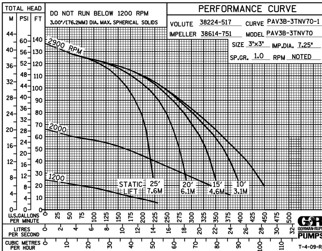
**\* STANDARD PERFORMANCE FOR PUMP MODEL PAV3B60C-3TNV70**
