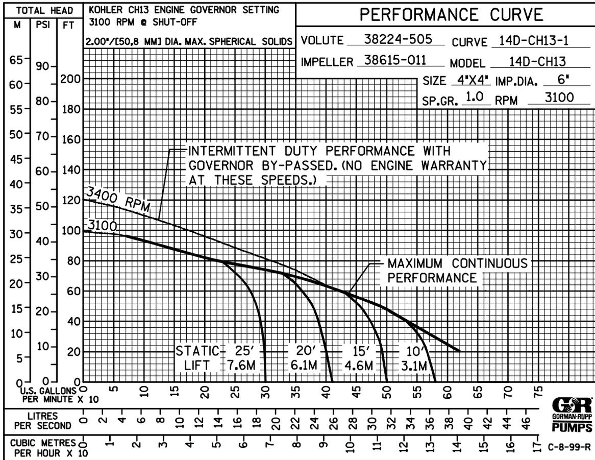
\* STANDARD PERFORMANCE FOR PUMP MODELS 14D52-CH13 And 14D52-CH13 S/G
