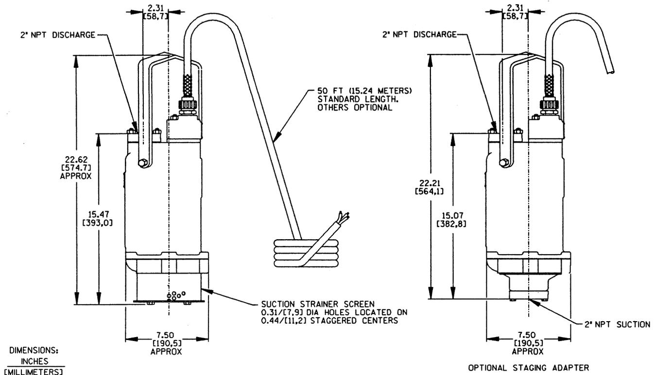
Figure 1. Pump Model S2F1-E1 (All Voltages)
