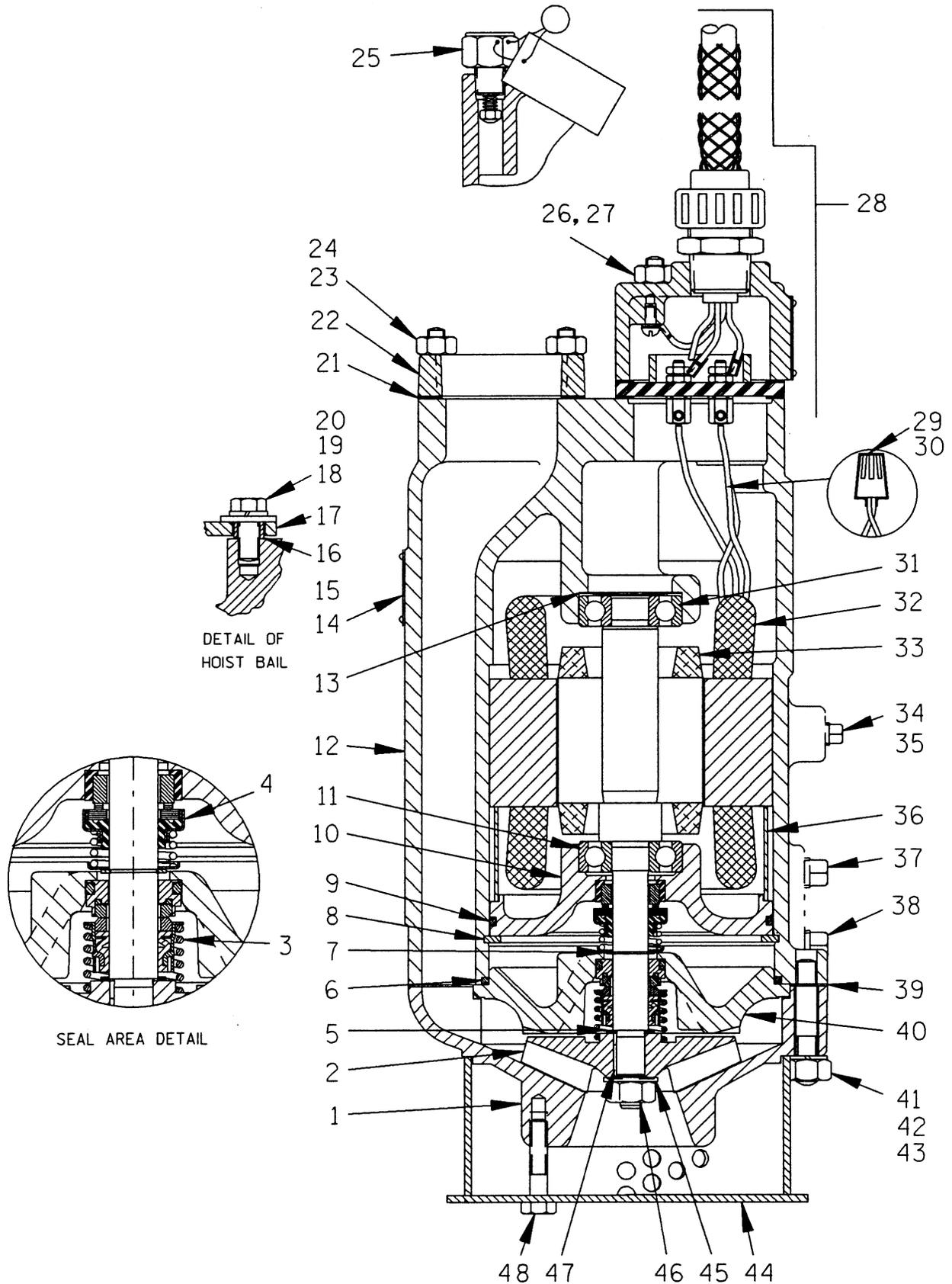
Figure 1. Pump Model S2F1-E1
