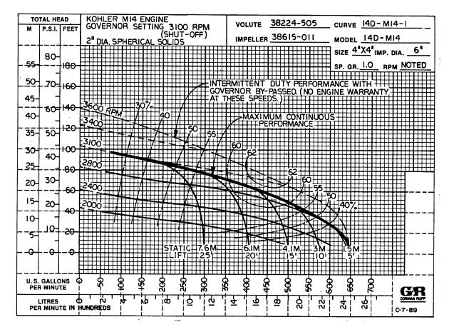
\* STANDARD PERFORMANCE FOR PUMP MODELS 14D2-M14 AND 14D2-M14 S/G
