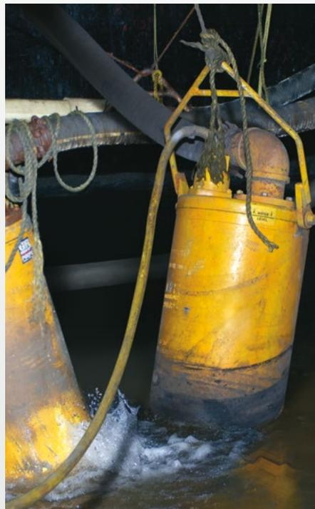
**Las bombas sumergibles Gorman-Rupp Serie S están diseñadas específicamente para achique de agua eficiente y económico. Estas bombas funcionan silenciosamente bajo la superficie, lo que las hace menos propensas al vandalismo y a las condiciones climáticas que las bombas de superficie.**
