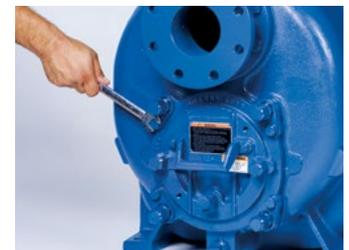
Una vez que se hacen los ajustes, el collar se bloquea y mantiene la graduación de la holgura incluso cuando se quita la cubierta de inspección. Esta característica del diseño duplica la vida útil de la placa de desgaste a la vez que mantiene la eficacia operativa al máximo.
