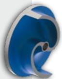
Las bombas Eradicator Plus™ están equipadas con un impulsor de álabe continuo, robusto y resistente, construido con hierro endurecido G-R para las aplicaciones de manejo de residuos más agresivas. Las venas incorporadas en la gruesa cubierta posterior ayudan a evitar que se acumulen restos detrás del impulsor.
