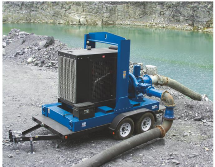
**aplicación Las bombas PAH Series® pueden montarse en un remolque o en una base móvil para aumentar su portabilidad en minas y obras.**
